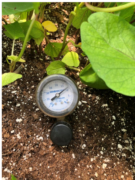
Photo 9 : Un tensiomètre inséré jusqu'à la profondeur de la semence de la patate douce.
